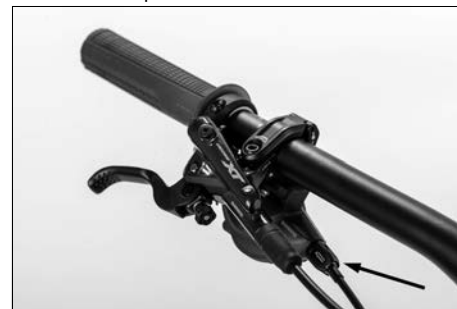
Obr. 25: Řazení převodových stupňů včetně nastavovacího pouzdra
