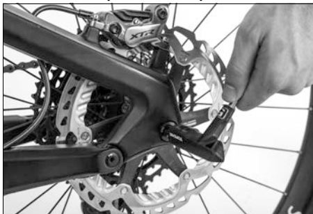
Obr. 43: Montáž systému středových os zadního kola
