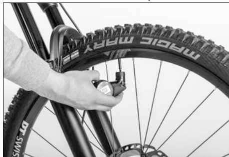
Obr. 13:Kontrola tlaku vzduchu v pneumatikách
