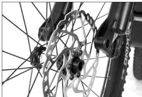
Obr. 40: Montáž šroubových spojů osy / předního kola
