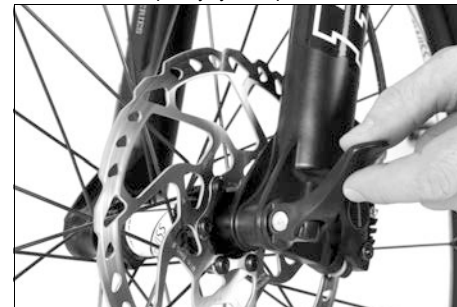
Obr. 42: Zavření páčky rychloupínacího mechanismu
