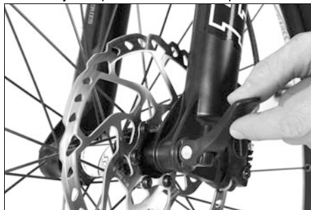
Obr. 40: Montáž šroubových spojů osy / předního kola
