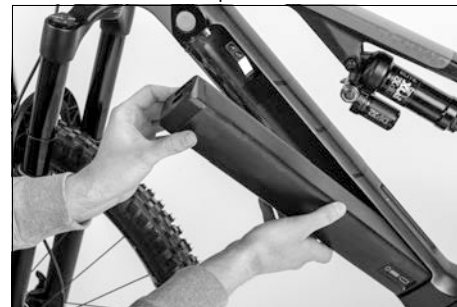
Obr. 28: Montáž baterie pohonu
