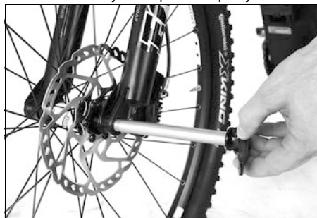
Obr. 41: Montáž systému přední nápravy
