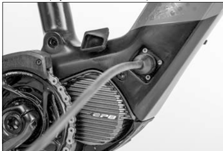
Obr. 23: Připojovací konektor ve správné poloze
