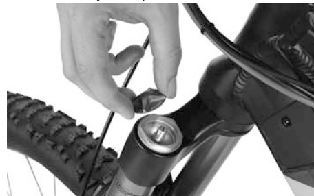
Obr. 31: Tlakový ventil pro nastavení tlaku vidlice
