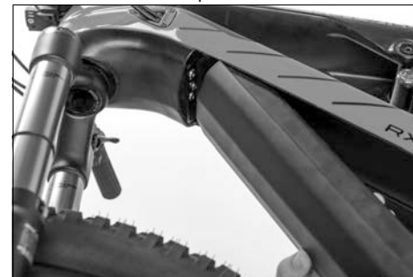
Obr. 33: Montáž baterie pohonu
