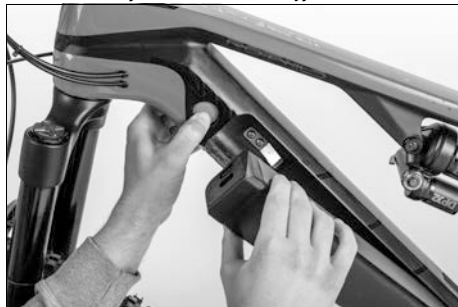
Obr. 26: Aktivujte mechanismus vyjmutí
