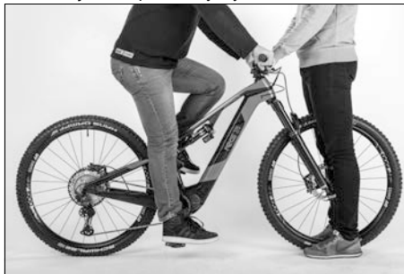
Obr. 25: Zjištění správné výšky sedla
