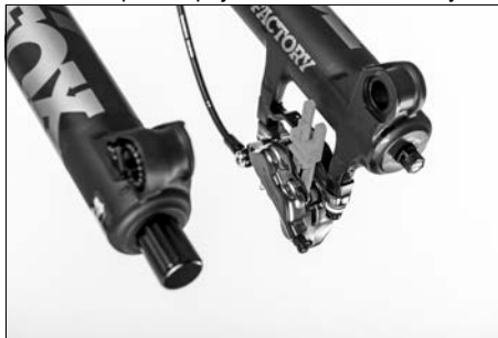
Obr. 44:Přepravní pojistka kotoučové brzdy
