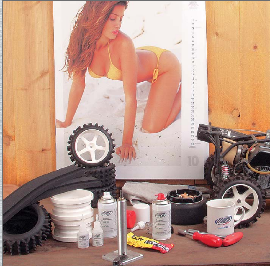
Benötigtes Zubehör zum Aufziehen und Verkleben von Off-Road Noppenreifen.
